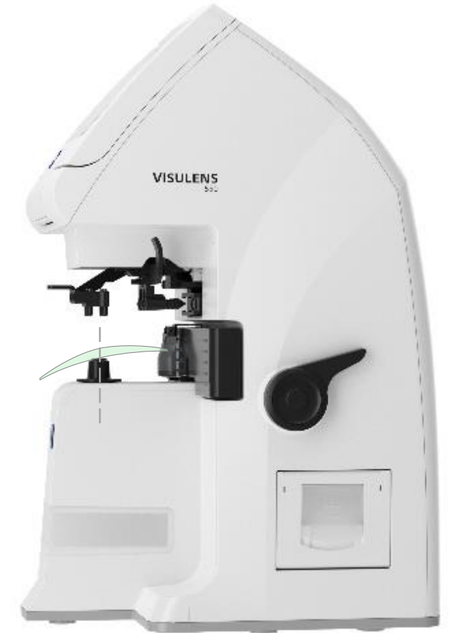
Lēca dioptrmetrā ievietota slīpi (optiskās asis nesakrīt)
